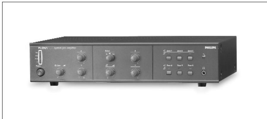
斑丽系列系统前置放大器 LBB 1925/10 是高性能、多用途的可播放呼叫和背景音乐的单声道放大器，能满足各种公共广播应用的广泛要求。它采用 2 个单声道同时操作的工作模式，可以通过功率放大器的接入，把呼叫和背景音乐播放到最多 6 个区。也可以采取一个单声道的模式，这种情况仅需用一个功率放大器。
